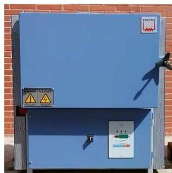
Las resistencias están dispuestas por encima y por debajo de la carga. El programador de temperatura TC-600/3 dispone de lazo de seguridad de sobretemperatura independiente y permite programar hasta 30 curvas de 30 segmentos cada una.
